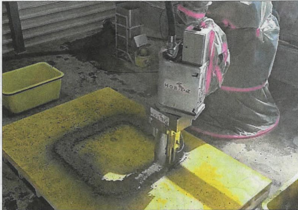
L'imprimante 3D en pleine fabrication d'un élément en béton sans usage de coffrage.
